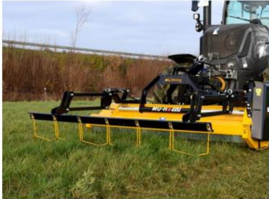
Abb. 58: Abstreifvorrichtung BeeHappy an MU-Ökotop-Mulchgerät (Quelle: Müthing GmbH & Co. KG Soest)
