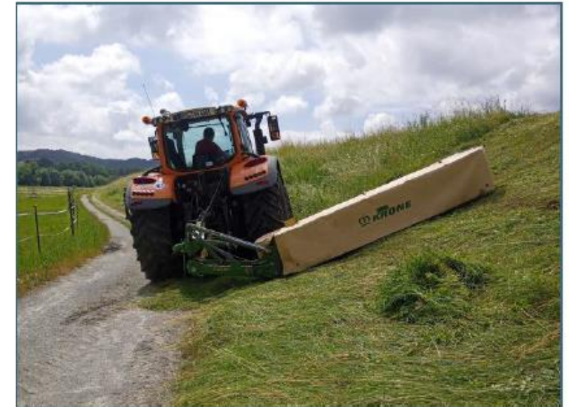
Abb. 42: Mäh der Deichböschung mit einer Zugmaschine mit Ausleger unter Nutzung des Deichverteidigungsweges
