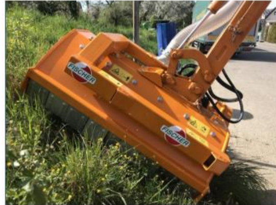
Abb. 59: Grünpflegekopf EcoCut mit horizontalem Gebälse zum Verwehen der auf den Halmen sitzenden Insekten vor der Überfahrt (Quelle: Fischer Maschinenbau GmbH)
