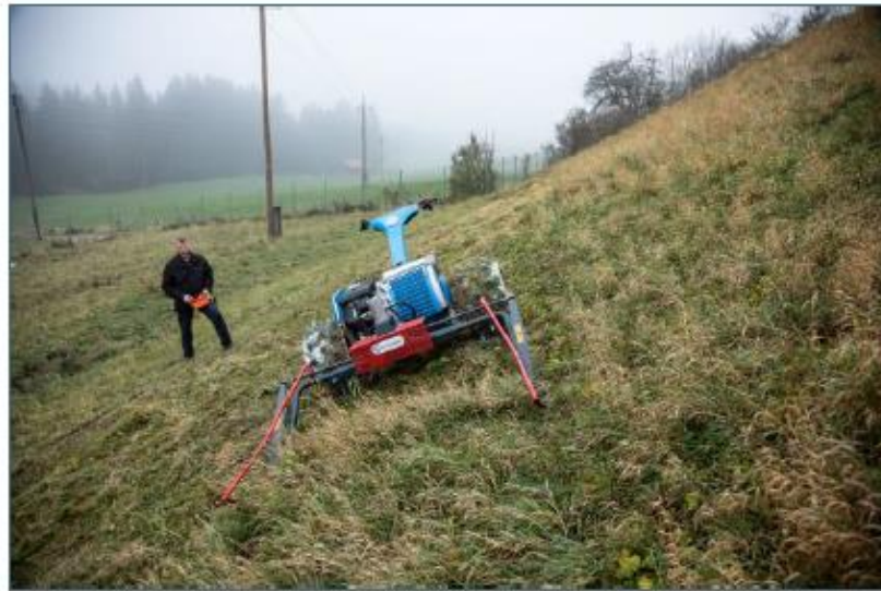
Abb. 38: Ferngesteuerte Hand-Motormäher sorgen insbesondere an steilen Hanglagen für eine erhöhte Arbeitssicherheit (Quelle: Brielmaier Motormäher GmbH)
