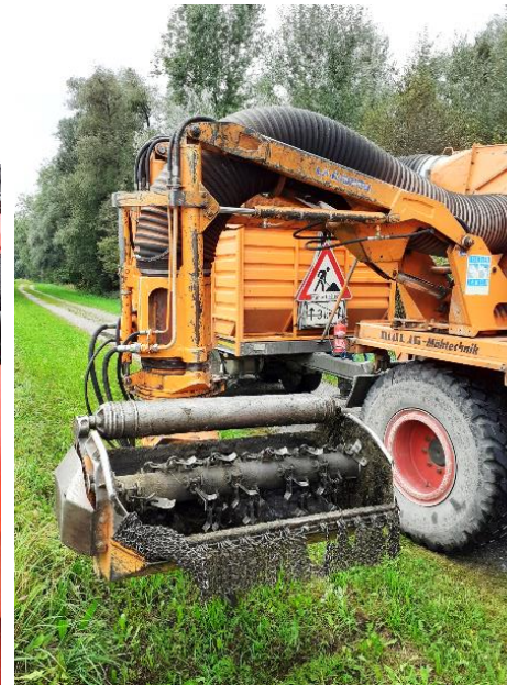
Auslege-Mähkopf mit Y-Schlegelmessern + Saugvorrichtung
